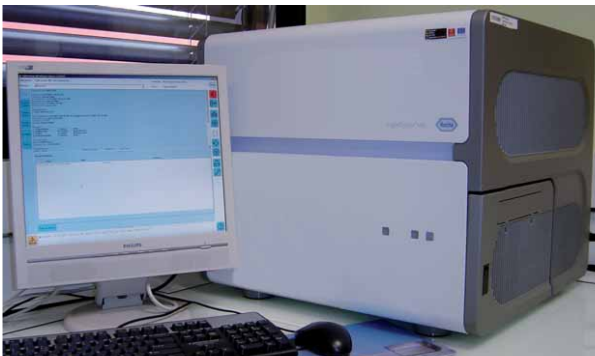
PCR quantitative Roche LightCycler 480 avec HRM
